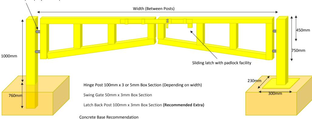
Concrete In: D 800mm x W 500mm x L 500mm
